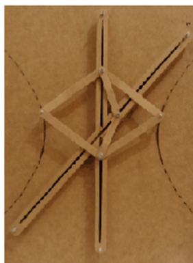
Figura 52 - Hipérbole utilizando um instrumento na forma de losango
