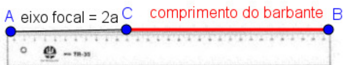
Figura 49 - Construção de uma hipérbole usando régua e barbante
