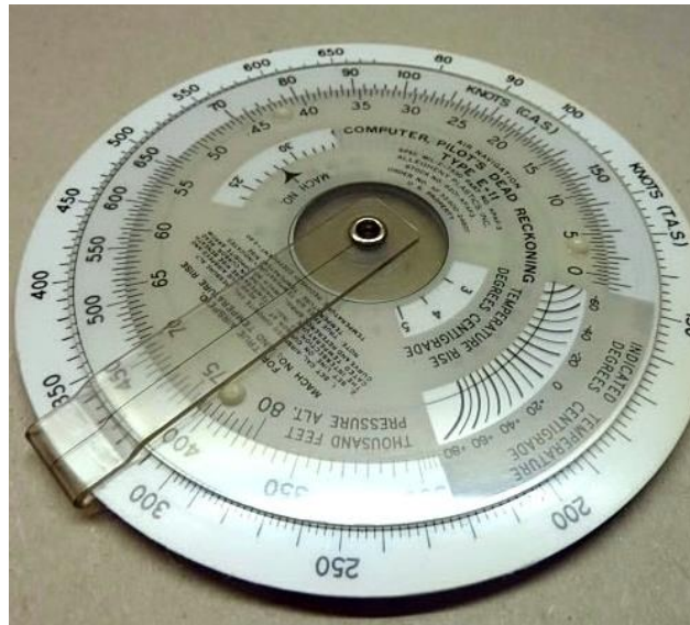
Figura 3-2: O Computador de Voo é um instrumento que resolve os principais cálculos de navegação aérea e utiliza escalas logarítmicas.
