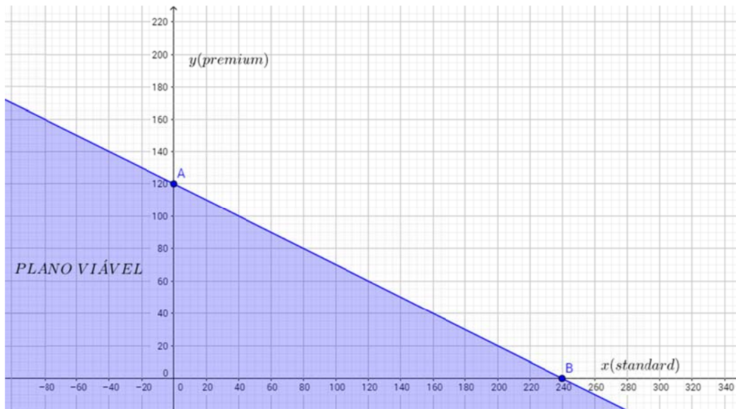
Figura 29: Região plana dada por y \leq 120 - 0,5x e os pontos A = (0, 120) e B = (240, 0) .
