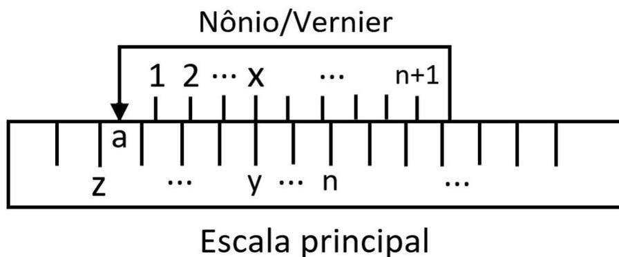
Figura 2.17: Esquema de medição do nônio
