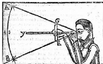
Figura 2.27: Observação da distância angular entre duas estrelas.
