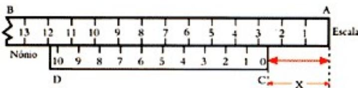
Figura 2.16: Medição com o nônio de vernier.
