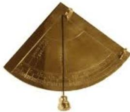
Figura 2.1: Quadrante com fio de prumo
