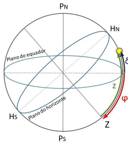
Figura 1.10: Latitude obtida com o zênite ao sul do Sol
