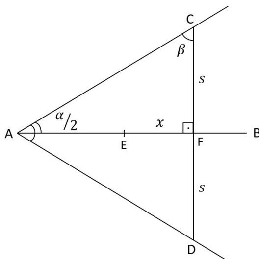
Figura 2.34: Esquema geométrico da balestilha
