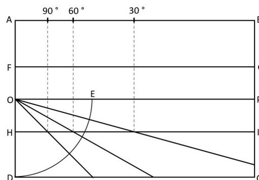
Figura 2.32: Esquema para graduação geométrica da balestilha
