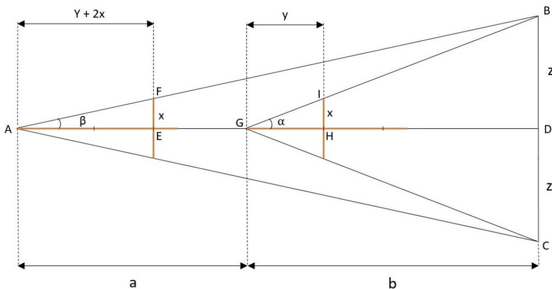
Figura 2.30: Esquema matemático de uma observação com o báculo de Jacob
