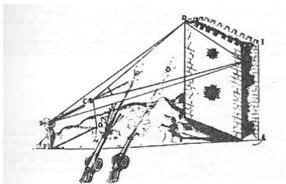
Figura 2.29: Exemplo da medição de uma distância com o báculo de Jacob
