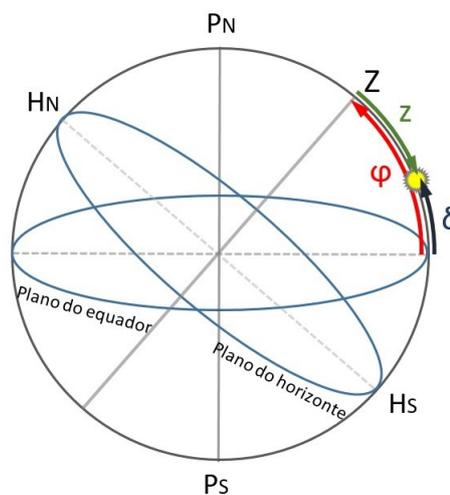
Figura 1.9: Latitude obtida com o zênite ao norte do Sol
