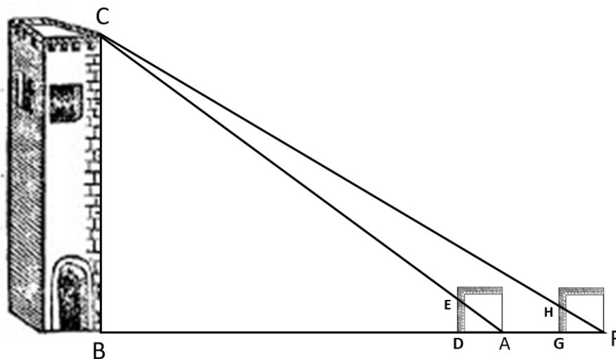
Figura 2.6: Posição dupla do quadrante para medir a altura da torre
