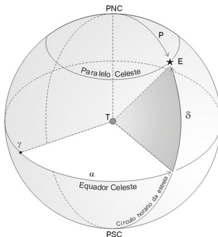
Figura 1.5: Sistema Equatorial de Coordenadas
