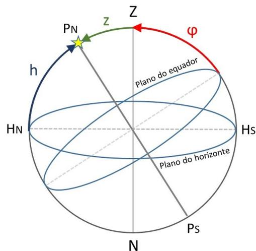
Figura 1.8: Latitude obtida pela altura da Estrela Polar
