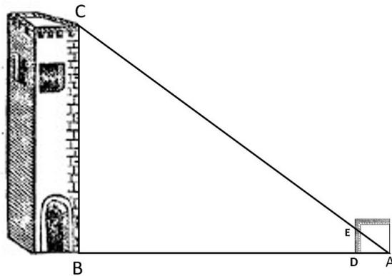
Figura 2.4: Posição do quadrante para medir a altura da torre
