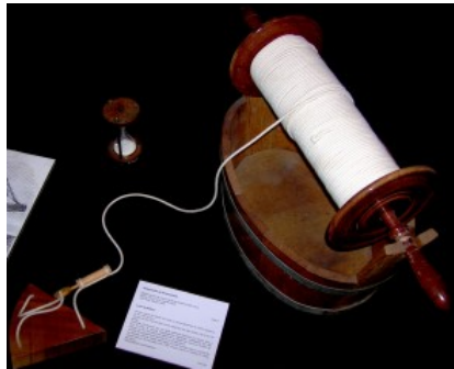
Figura 3: Instrumento utilizado no século XVI para medir a velocidades de embarcações
