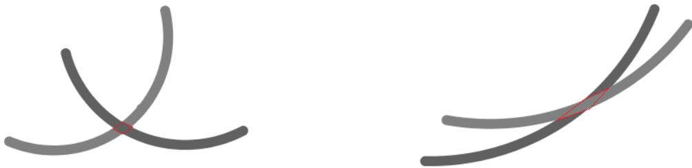
Figura 3.7: Um ângulo de interseção grande à esquerda e um ângulo pequeno à direita (perda de precisão).
