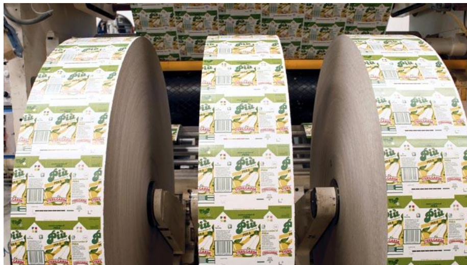
Figura 32 – Bobinas de envaze para embalagens longa vida de leite e suco.
