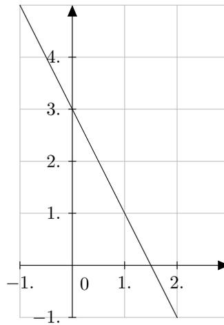
Figura 15 – Representação geométrica da reta com equação cartesiana  $2x + y = 3$
