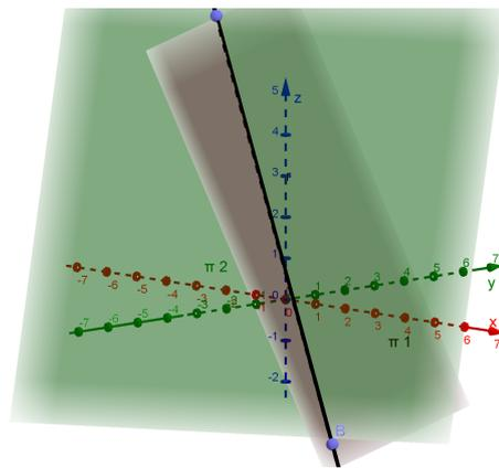
Figura 22 – Representação geométrica do sistema (5.18)
