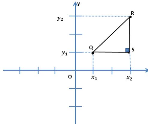
Figura 6 – Representação geométrica de distância entre dois pontos
