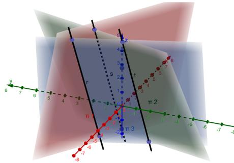
Figura 29 – Representação geométrica do sistema (5.25)
