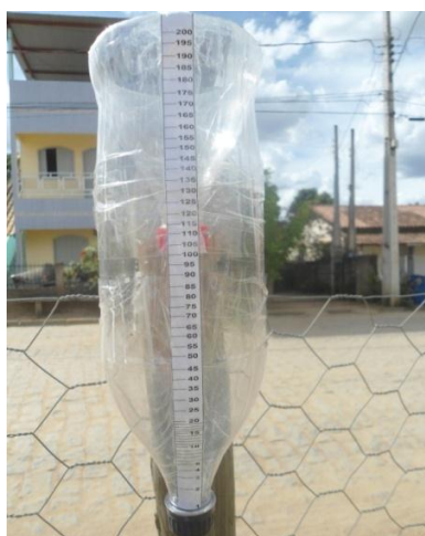
Figura 50: Pluviômetro pronto para receber água da chuva
