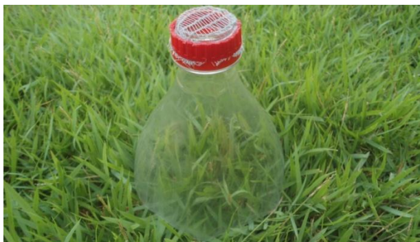
Figura 48: Pet cortado a 11,5 cm do bico
