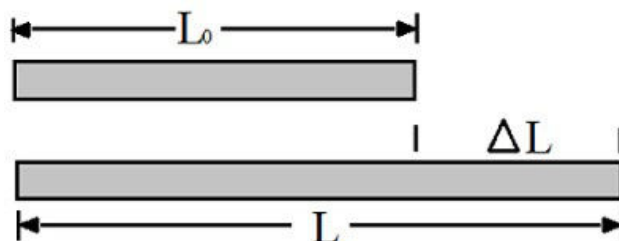
Figura 3.5: Dilatação sofrida por uma barra metálica
