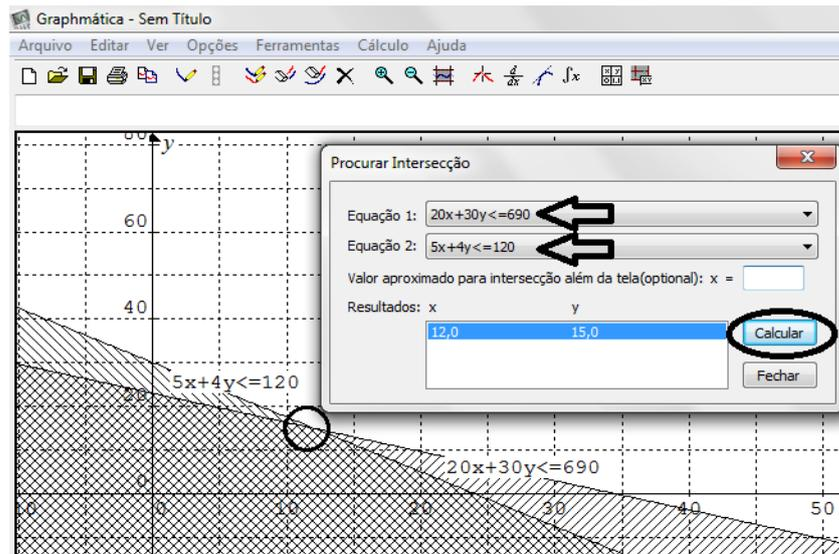
Figura 3.7– Intersecção das inequações restrição.
