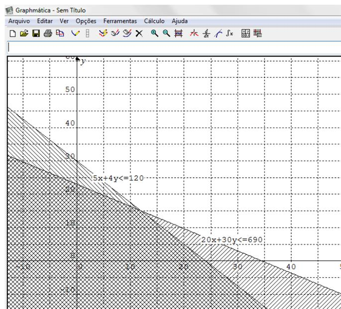
Figura 3.10 – Intersecção dos semi-planos para determinar a região viável.
