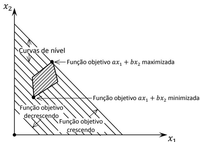
Figura 2.6 – Uma função assume seu valor máximo e mínimo em um conjunto convexo não vazio e limitado em um ponto extremo.
