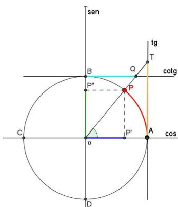
Figura 1.13: Circunferência trigonométrica e projeções do arco  $x$  nos eixos.
