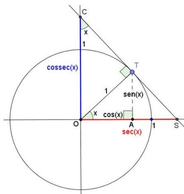
Figura 1.14: Circunferência trigonométrica e projeções do arco  $x$  nos eixos.
