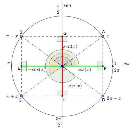
Figura 1.12: Correspondência dos arcos no círculo trigonométrico
