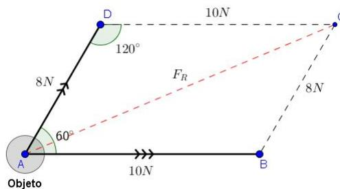
Figura 2.9: Obtenção da Força resultante  $F_R$  aplicada a dois vetores de força  $F_1$  e  $F_2$ .
