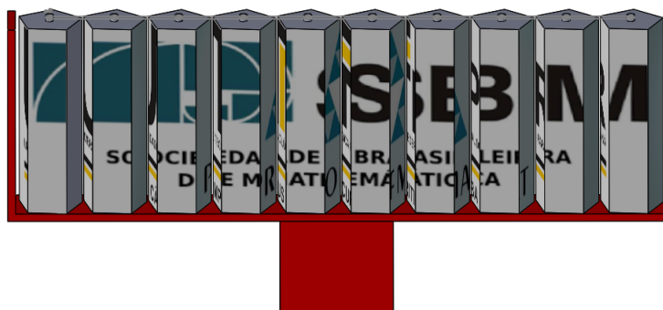
Figura 20 – Painel formado por prismas pentagonais.
