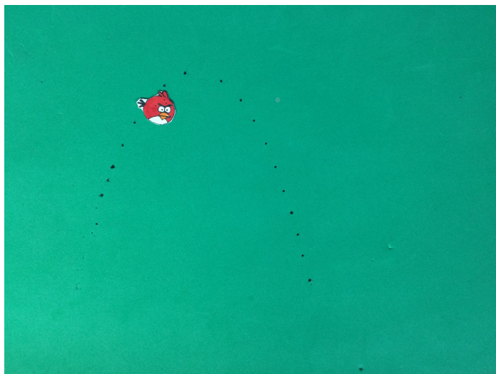
Figura 4.2: Parábola marcada no fundo verde para utilização da técnica Chroma Key
