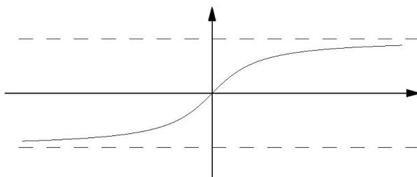
Figura A<sub>7</sub> - Função Arco Tangente
