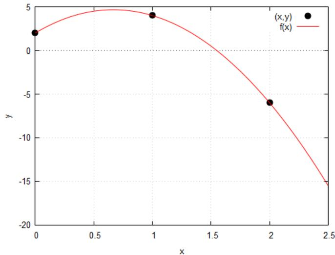
Figura 2.3: Função interpoladora  $f(x) = -6x^2 + 8x + 2$ .
