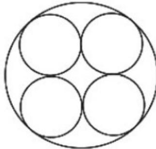
Suponha que você seja o operador da máquina que produzirá os tubos maiores em que serão colocados, sem ajustes ou folgas, quatro tubos cilíndricos internos.
