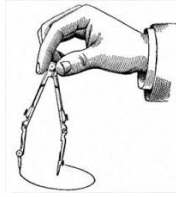
Figura 5.9: Construção da circunferência utilizando um compasso
