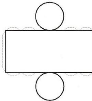
Figura 27 – Forma planificada de um cilindro reto
