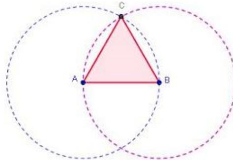
Figura 8 – Construção do Triângulo Equilátero ABC
