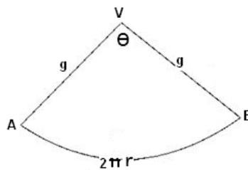
Figura 28 – Forma Planificada da Lateral de um Cone Reto a Partir de um Setor Circular de Raio  $g$  e Centro em  $V$
