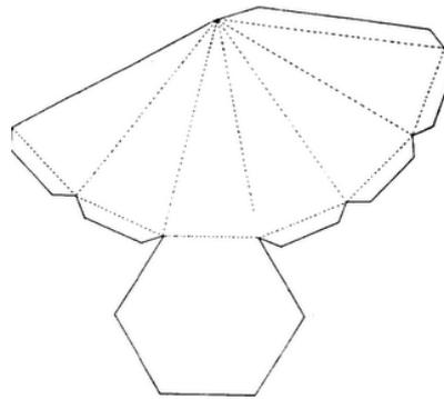
Figura 33 – Forma Planificada de uma Pirâmide Hexagonal Regular
