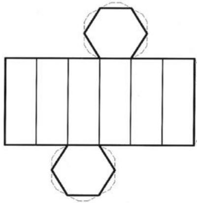
Figura 32 – Forma Planificada de um Prisma Hexagonal Regular
