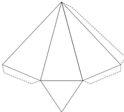
Figura 31 – Forma Planificada de uma Pirâmide Triangular Regular
