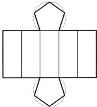
Figura 23 – Forma planificada de um prisma pentagonal regular
