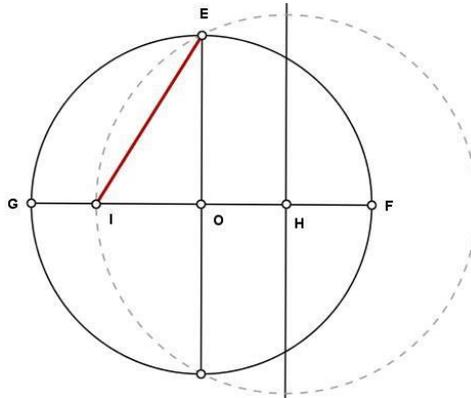
Figura 13 – Segmento EI como lado do Pentágono Regular
