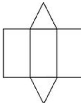
Figura 24 – Forma planificada de um prisma triangular regular
