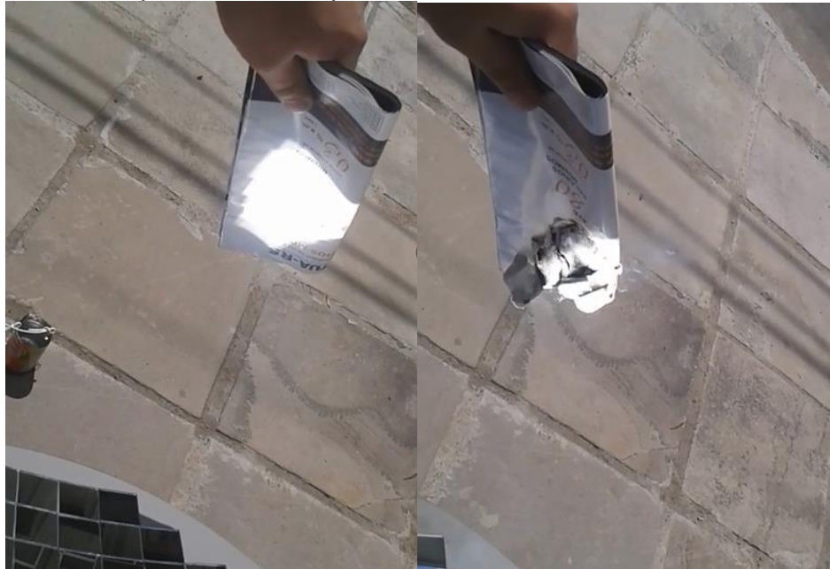
Figura 25 – Papel incendiado pelos raios concentrados no foco do refletor
