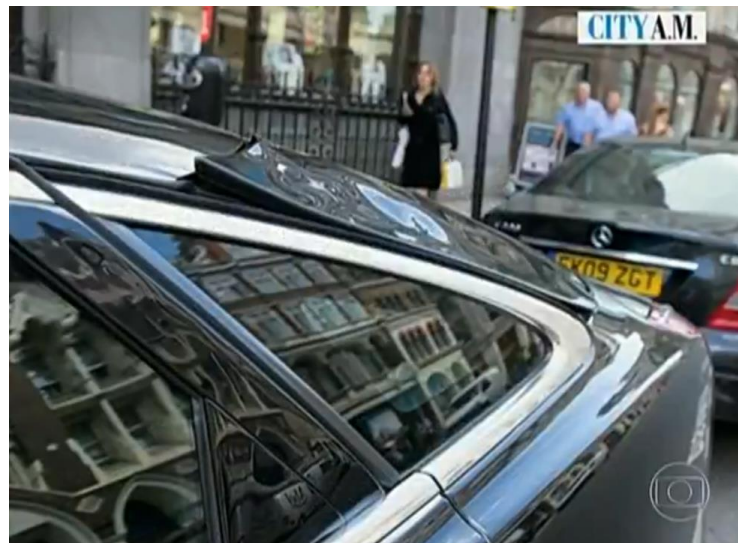
Figura 24 – Carro com a lataria e espelho com marcas de derretimento devido a reflexão da luz solar
