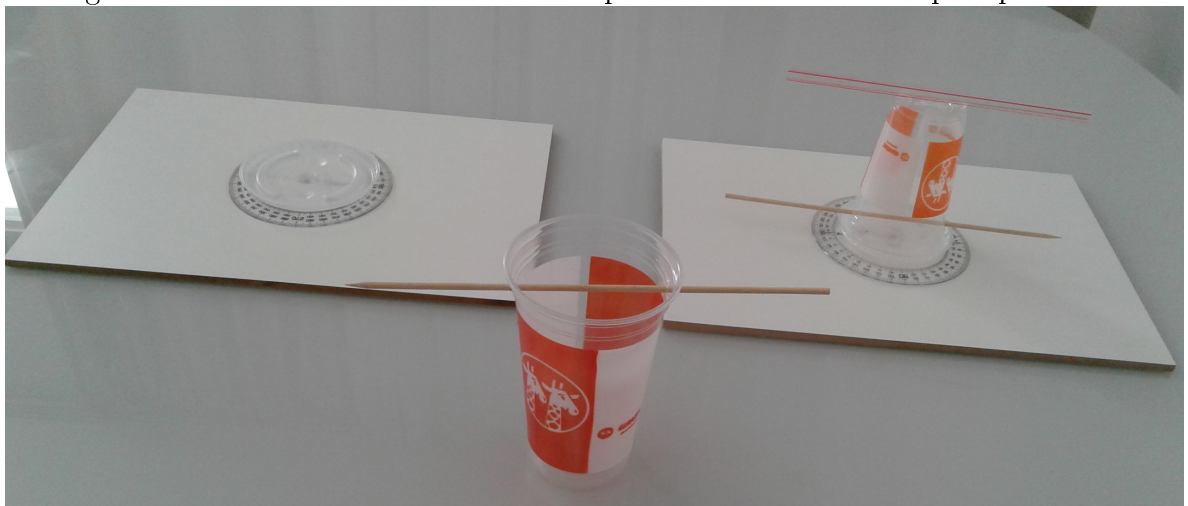
Figura 42: Teodolito caseiro construído pelos alunos orientados pelo professor.
