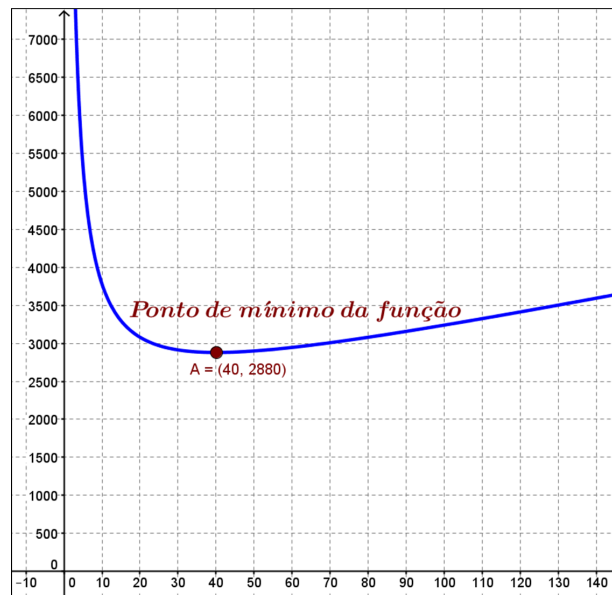
Figura 32: Gráfico da função A(x) = 10x + 16000x^{-1} + 2080 que determina a área do lote.
