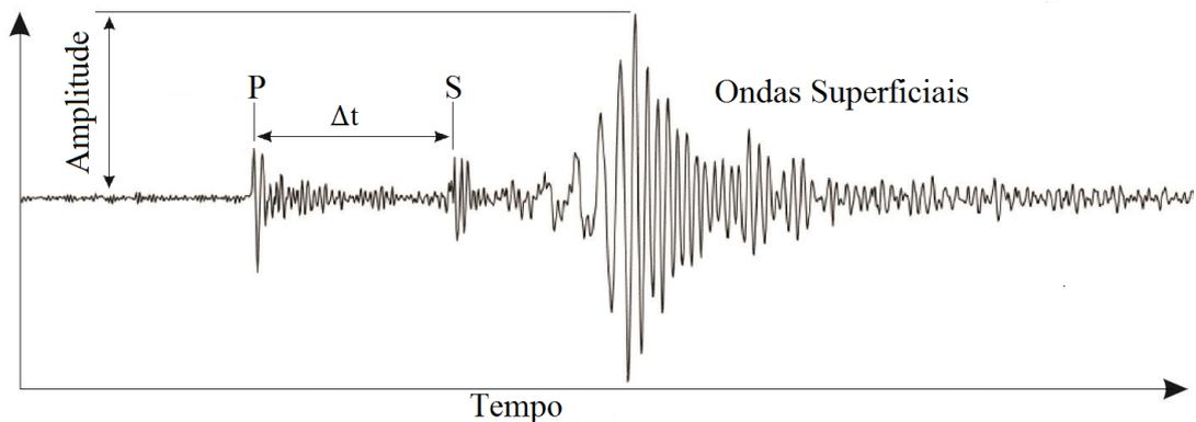
Figura 5.5: Sismograma de um terremoto.
