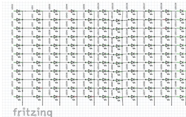
Figura 2.13: Conexões da matriz de LEDs.
