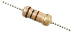
Figura 2.7: Resistor de filme plástico.
