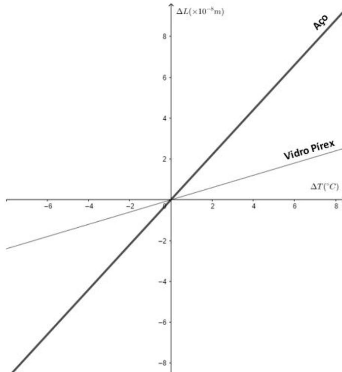
Figura 5.4: Dilatação do aço e do vidro pírex em função da variação da temperatura.
