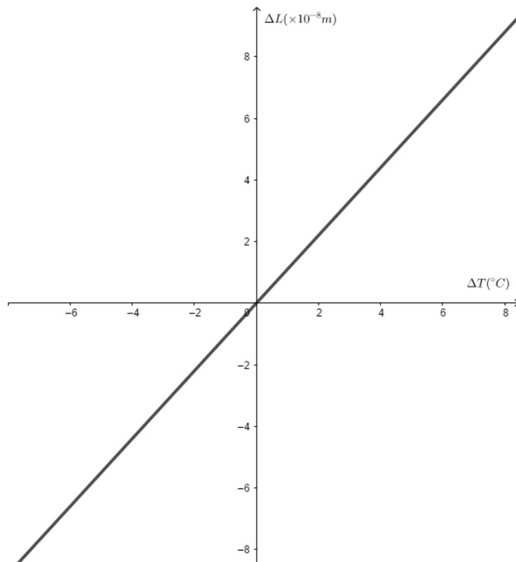
Figura 5.2: Dilatação do aço em função da variação da temperatura.
