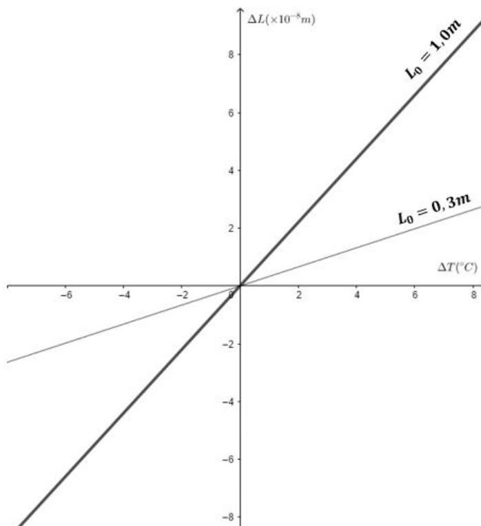
Figura 5.5: Dilatação do aço para diferentes comprimentos iniciais.
