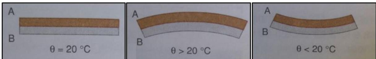
Figura 5.6: Funcionamento da lâmina bimetálica.
