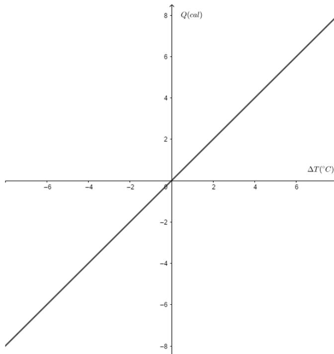
Figura 4.2: Quantidade de calor da água em função da variação da temperatura.
