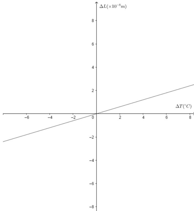
Figura 5.3: Dilatação do vidro pírex em função da variação da temperatura.
