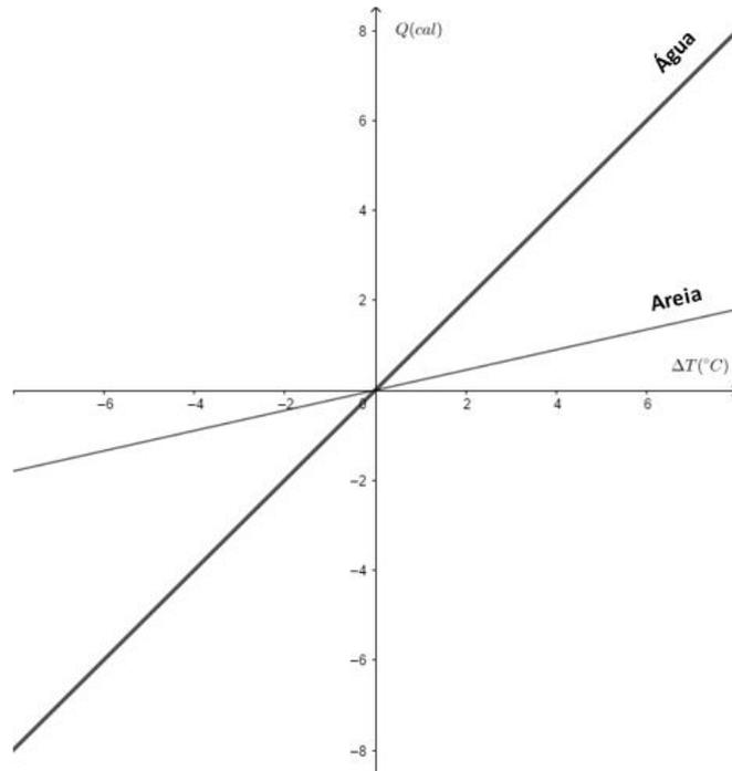
Figura 4.4: Quantidade de calor da água e da areia em função da variação da temperatura. (Fonte: autor.)
