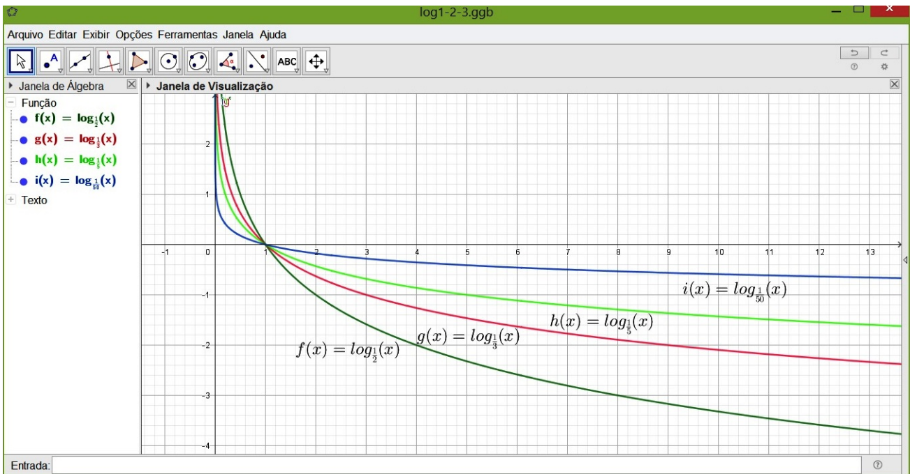
Figura 4.13 – Funções f(x) = \log_{\frac{1}{2}} x , g(x) = \log_{\frac{1}{3}} x , h(x) = \log_{\frac{1}{5}} x e i(x) = \log_{\frac{1}{50}} x
