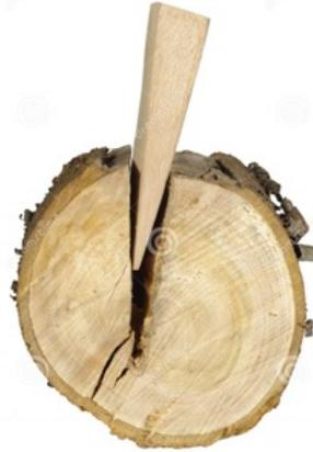
Figura 3.19: Cunha de madeira atravessada em um tronco
