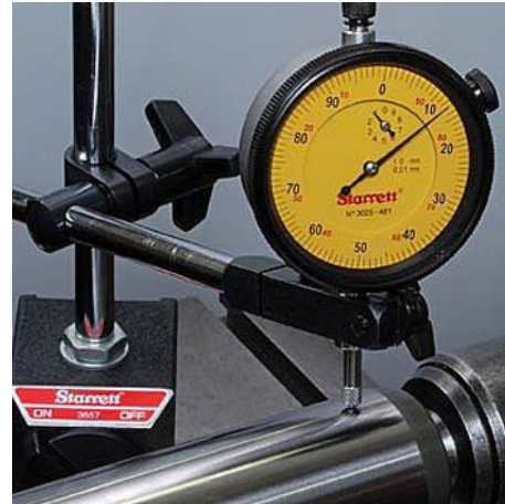
(b) Exemplo de utilização do Relógio Comparador
