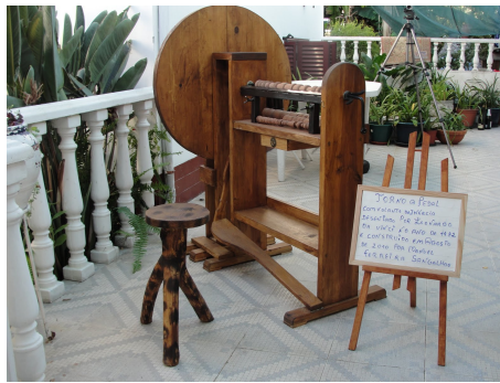
Figura 5.2: Protótipo do torno a pedal com volante de inércia desenvolvido por Leonardo da Vinci no ano de 1482.
