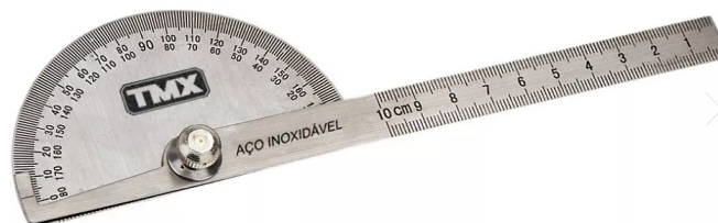
Figura 6.4: Modelo de um tipo de transferidor utilizado na indústria mecânica. Ele possui uma lamina que facilita o apoio da peça para a verificação do ângulo a ser medido.
