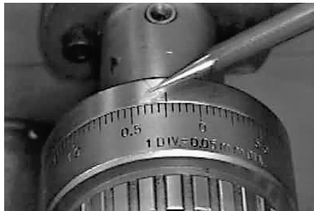
Figura 5.4: Colar Micrômetro de um Torno Mecânico: o colar dessa imagem possui a resolução de 0,05 mm
