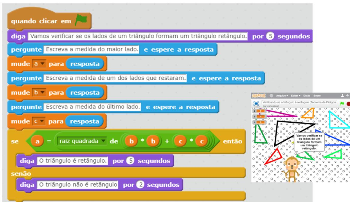
Figura 57 - Projeto no *Scratch* para verificar se um triângulo é um triângulo retângulo, usando o Teorema de Pitágoras.
