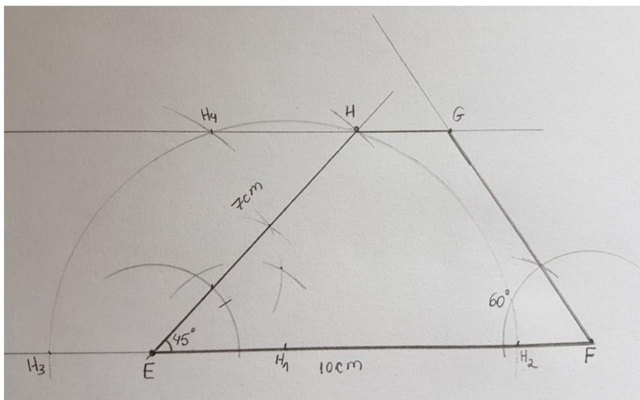
Figura 45 - Construção geométrica de um trapézio com régua e compasso.
