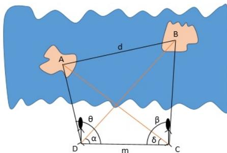
I passo: Na praia tomemos dos pontos de observação C e D, de modo que a distância (m) entre eles possa ser medida com uma trena, formando assim um quadrilátero com os pontos A, B, C e D.
