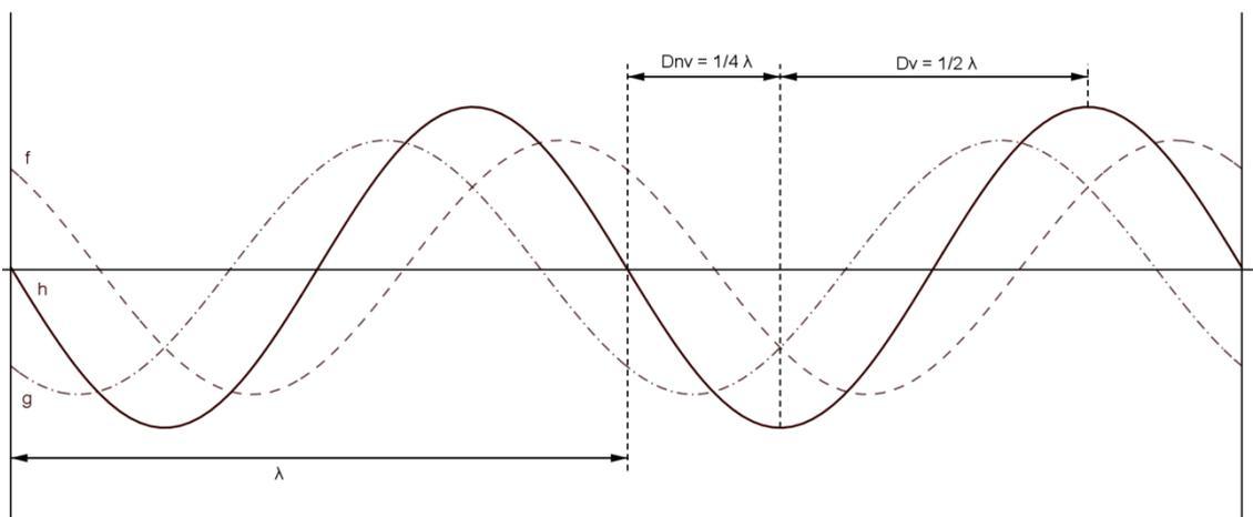
Figura 12 – Cálculo do comprimento de onda (onda estacionária h dada por  $h = f + g$ )
