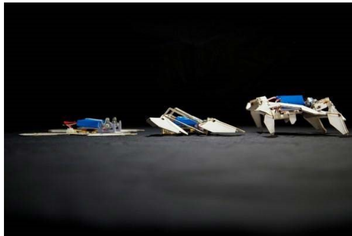
Figura: a sequência de automontagem do robô-origami: método simples, barato e versátil de construir equipamentos eletromecânicos.
