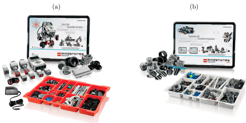
Figura 18 – Kit de Robótica LEGO Education MINDSTORMS EV3: (a) Kit EV3 MINDSTORMS Core Set , com 541 peças, para crianças a partir dos 10 anos; (b) Kit de expansão Expansion Set , com 853 peças.
