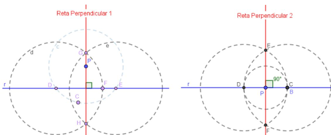
Figura 71 – Construção Perpendicular
