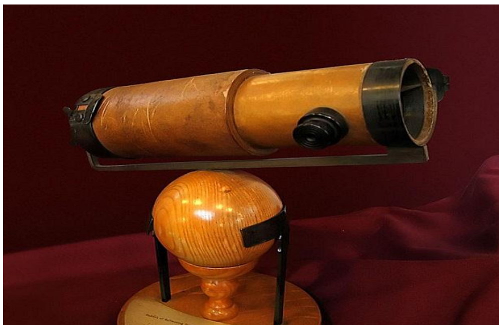
Figura 4 – Réplica do telescópio refletor de Isaac Newton
