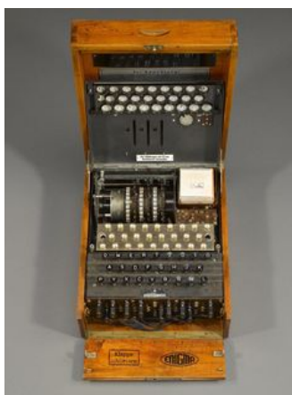
Figura 9 – Uma máquina Enigma usada pelo exército alemão com a tampa interna aberta, revelando seus componentes.
