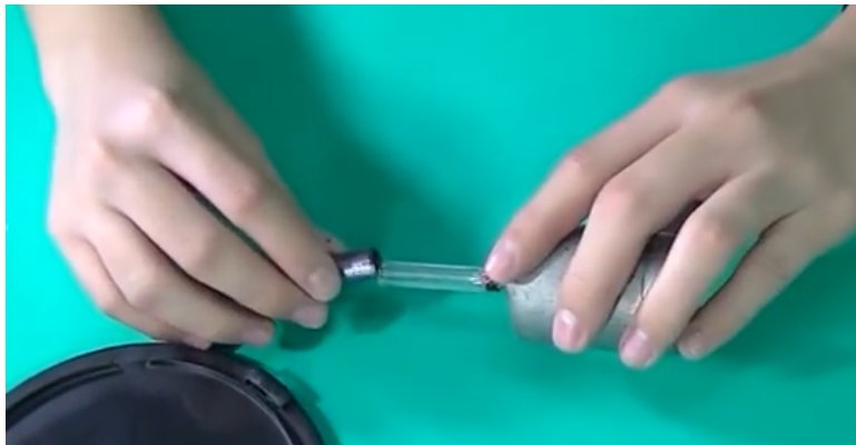
Figura C.2: Conexão interna do eixo do motor.
