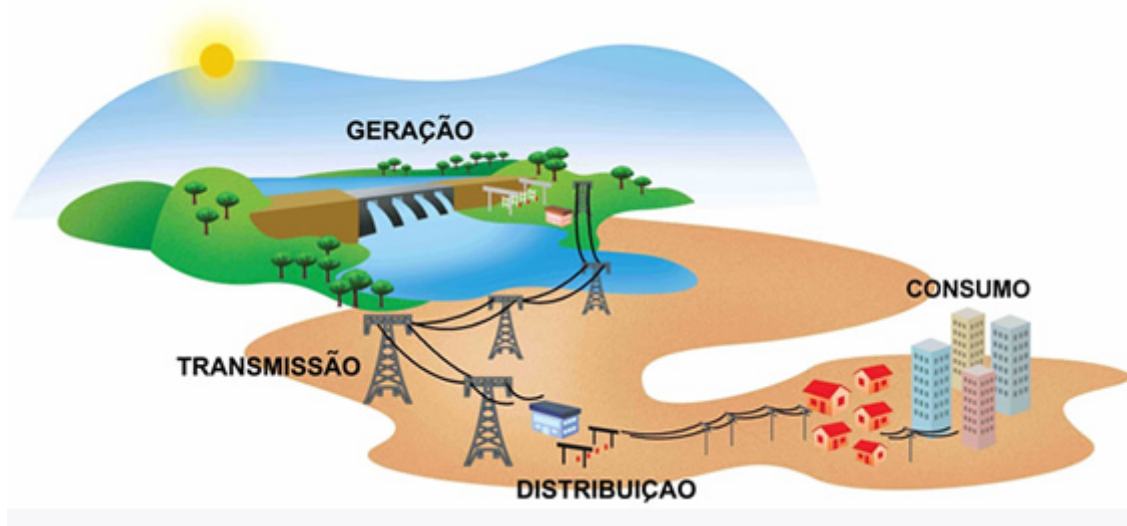
Figura 2.1: O caminho da energia elétrica da geração ao consumidor [1].
