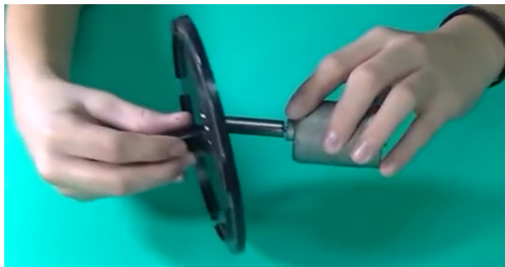
Figura C.3: Conexão do motor a base da turbina.
