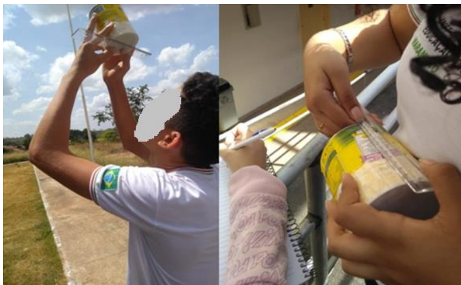
Figura 16 - À esquerda, aluno medindo a dimensão da imagem do sol. À direita, aluna medindo a dimensão da câmara escura.
