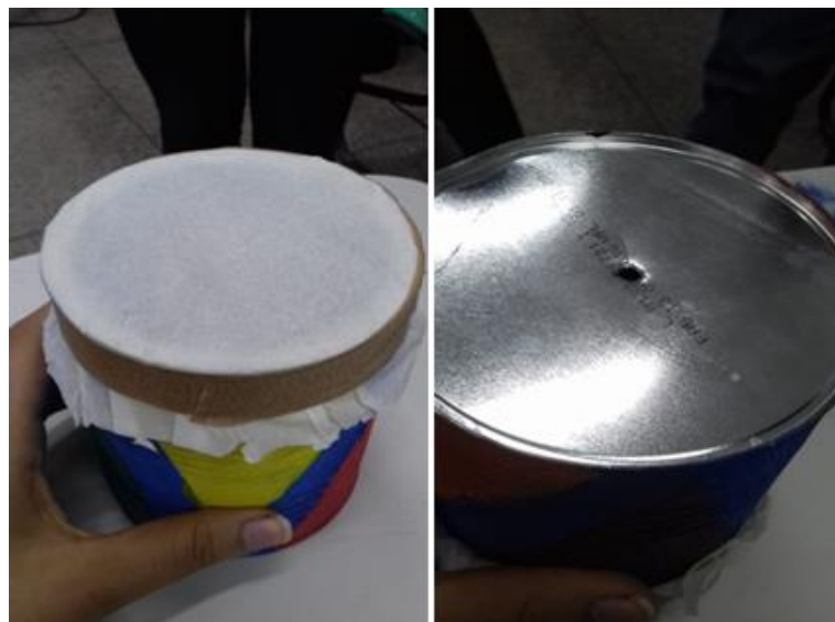
Figura 17 - Câmara escura construída pelos alunos.
