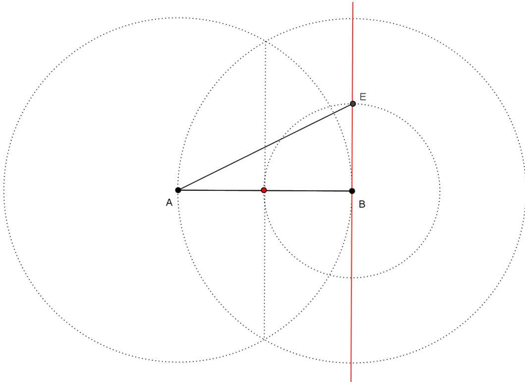
Construção do segmento áureo usando régua e compasso - Passo 5
