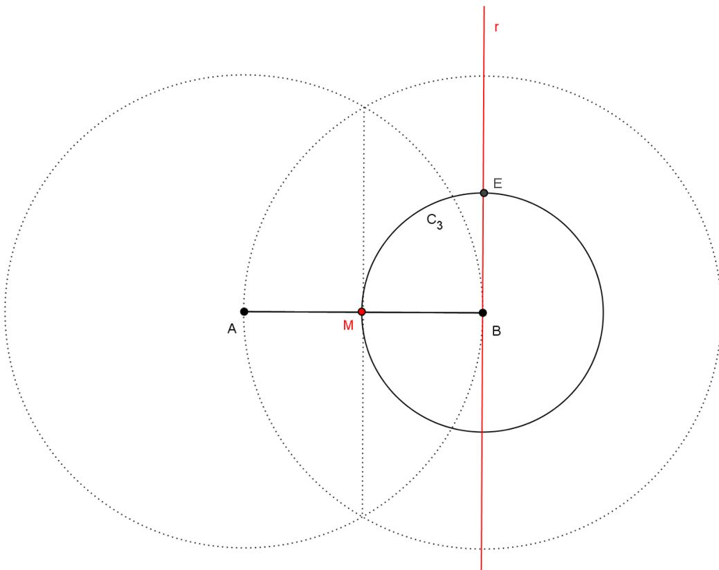
Construção do segmento áureo usando régua e compasso - Passo 4
