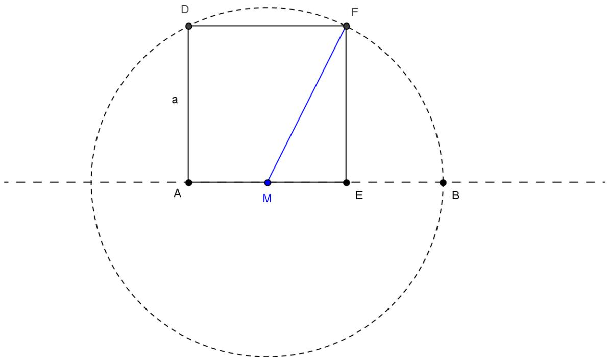
Construção de retângulo áureo usando régua e compasso - Passo 4
