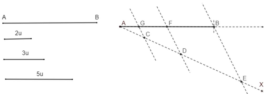
Figura 3.10: Segmento dividido em partes proporcionais a 2, 3 e 5.
