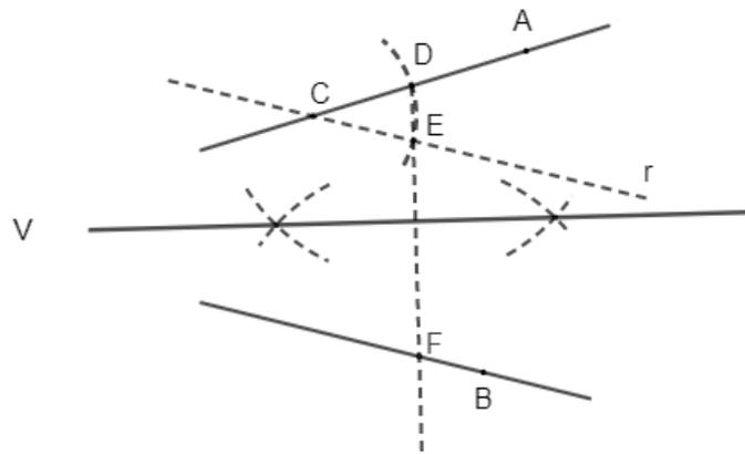
**Figura 2.31:** Bissetriz de um ângulo com vértice inacessível
