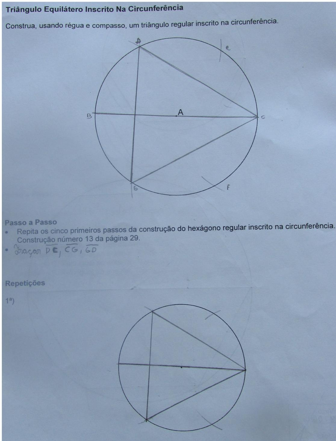
Figura A.5: Construção triângulo equilátero – Atividade 2
