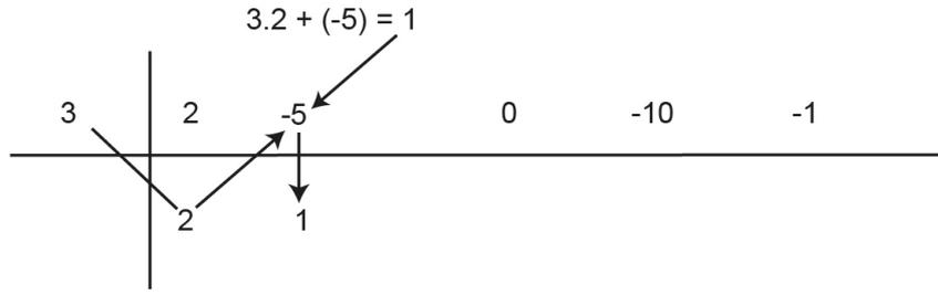
Figura 1.3: Terceiro passo do dispositivo de Briot-Ruffinni (Exemplo 1.1.14).
