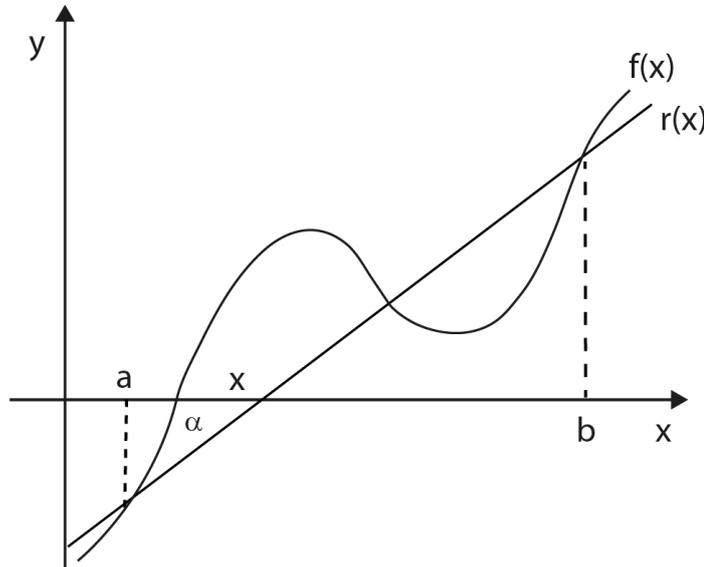
Figura 2.3: Interpretação Gráfica do Método da Posição Falsa
