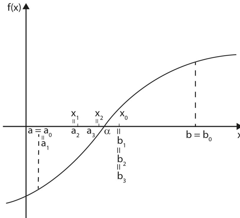
Figura 2.1: Interpretação gráfica do método da bisseção
