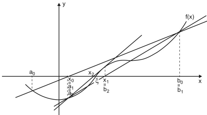
Figura 2.4: Interpretação Gráfica do Método da Posição Falsa.
