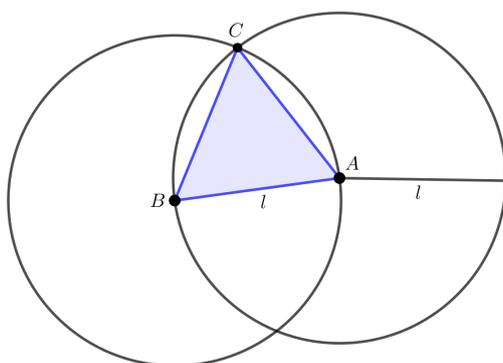
Figura 2.1: Construção de um triângulo equilátero com régua e compasso.
