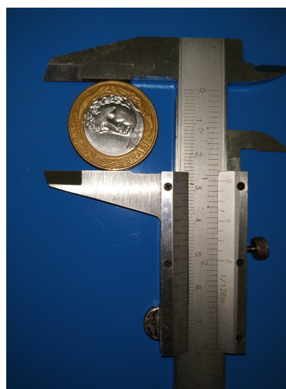
(b) Diâmetro de uma moeda através do paquímetro.
