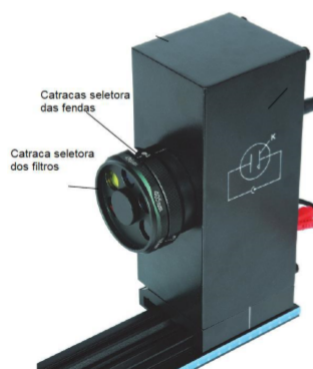
Figura 18 – Fotodiodo e suas catracas seletoras. Fonte: Referência [28].
