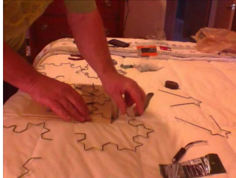
Figura: antena fractal inspirada no floco de neve de Koch.
