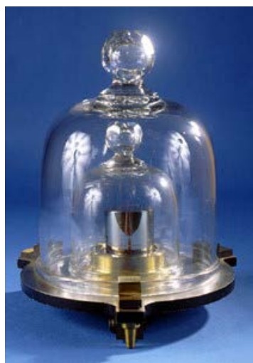
Figura: Protótipo do Quilograma K20 armazenado nos EUA (a cópia brasileira tem numeração K66).
