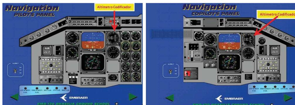
Figura 31 – Altímetro codificador e a localização no painel de instrumentos do **piloto** e **copiloto**
