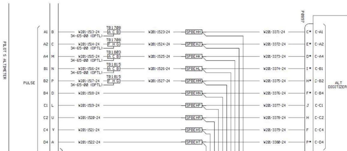
Figura 43 – Diagrama de fiação elétrica do EMB 120.
