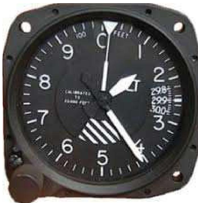
Figura 26 – Altímetro codificador indicando aproximadamente 14.000 pés
