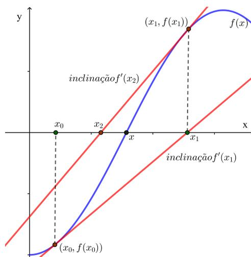
Figura 12: Raiz de  $f(x)$  por aproximação de retas tangentes, pelo método de Newton.
