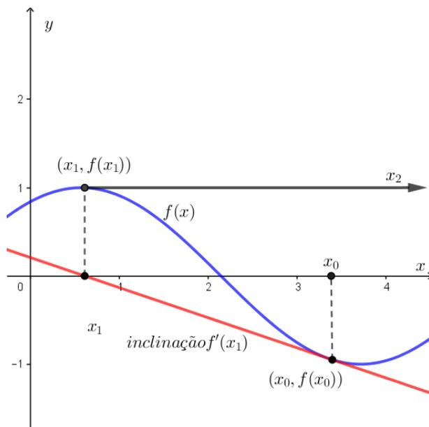
Figura 13: Aproximação da raiz de  $f(x)$  pelo método de Newton em um caso de não convergência
