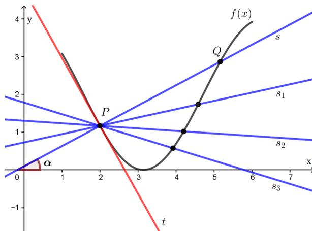
Figura 7: Reta  $s$  secante a curva  $f(x)$ , nos pontos  $P$  e  $Q$  e  $t$  tangente a  $f(x)$  no ponto  $P$ .
