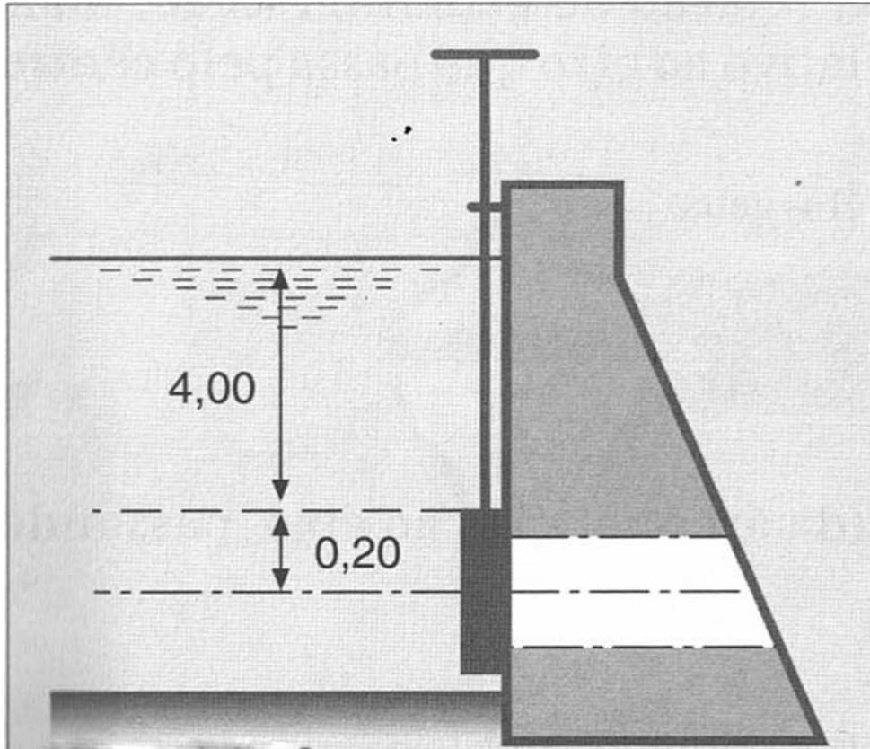
Figura 3.1: Barragem de concreto - exercício de Hidráulica
