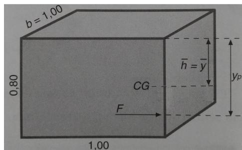
Figura 3.3: Caixa de água - exercício de Hidráulica
