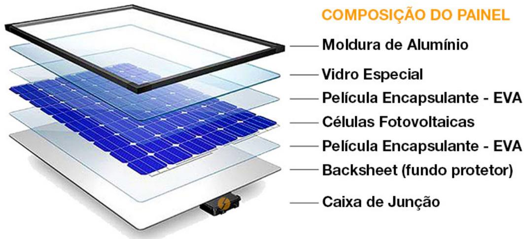
Figura 2.10: Módulo Fotovoltaico. Fonte: [13]
