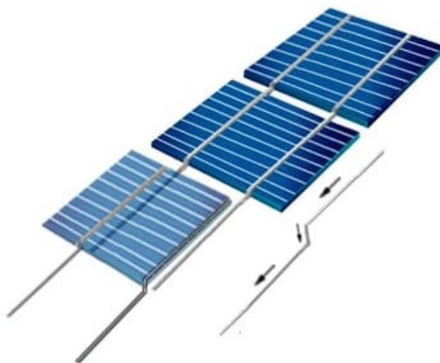
Figura 2.9: Ligação em série das células fotovoltaicas
