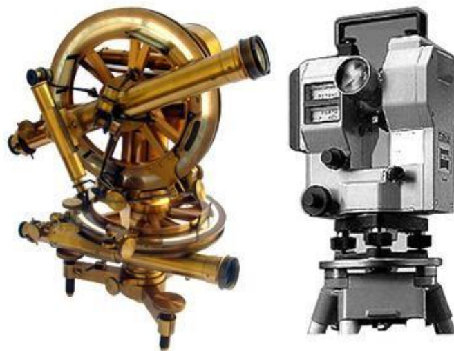
Figura 5 – À esquerda, um modelo de teodolito do século XIX e à direita, um teodolito eletrônico.
