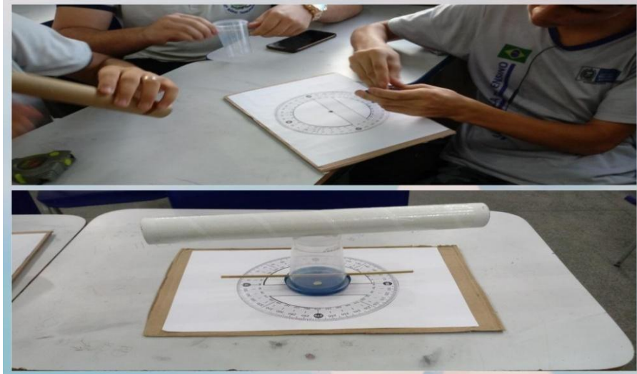
Figura 21 - Montagem do teodolito caseiro
