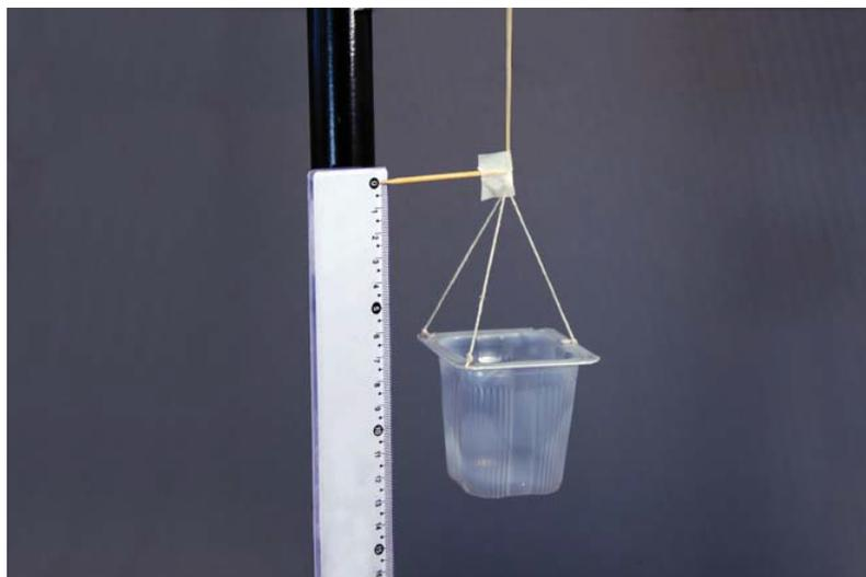
Figura 4.4: Passo III: construção dinamômetro
