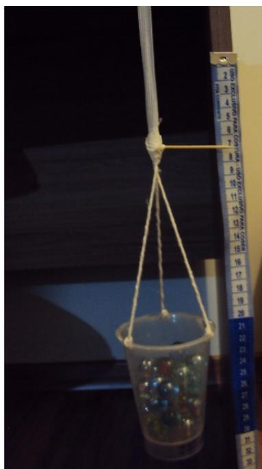
Figura 4.5: Passo IV: medir o comprimento do elástico
